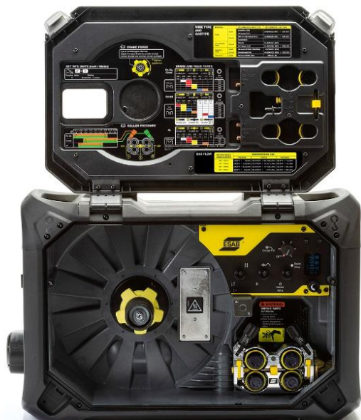
Interní světla LED a místo pro spotřební díly zabudované ve víku
